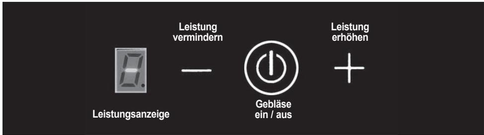
Bedieneinheit des Abluft-/Umluftmodules
